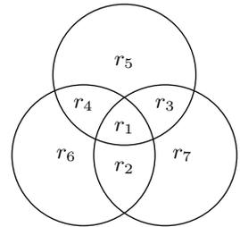
Рис. 3. Код Хэмминга с блоковой длиной 7
